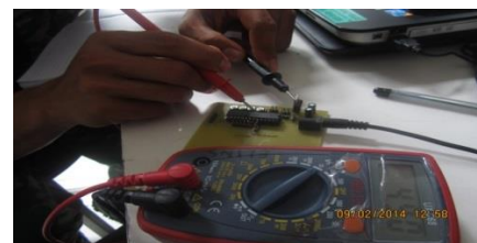
Gambar 4.14 Pengujian mikrokontroler ATMega8
