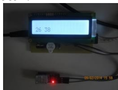
Gambar 4.7 Pengujian sensor DHT11 (Sumber: Pengujian)
