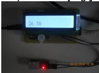
Gambar 4.10 pengambilan data suhu dan kelembaban ( sumber : perancangan )
