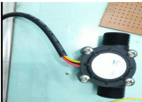
Gambar 4.3 Rangkaian Water Flow sensor ( sumber : pengujian )
