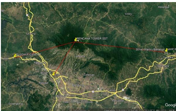
Gambar 1 Contoh tampilan google earth dalam menentukan lokasi pemasangan repeater
