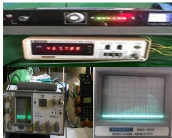
Gambar 4.12. Pengukuran *output alat jammer 452 MHz*
