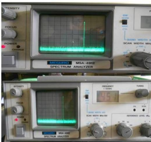
Gambar 4.10. *frekuensi output alat jammer 450 MHz*
