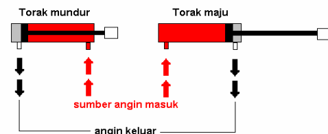
Gambar 2.2 Ilustrasi cara kerja silinder kerja ganda
