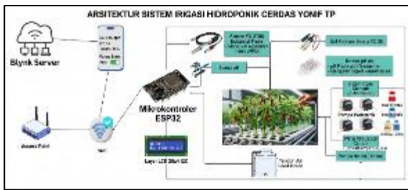
Gambar 2. Arsitektur Konektivitas IoT pada Sistem Irigasi (Sumber: Penulis, 2026).
