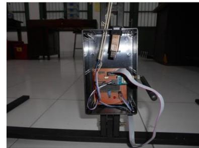
Gambar 4.4 Rangkaian Dudukan Sensor *Flexi Force*.
