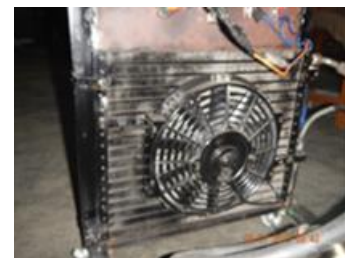
Gambar 6. Kondensor AC mobil
