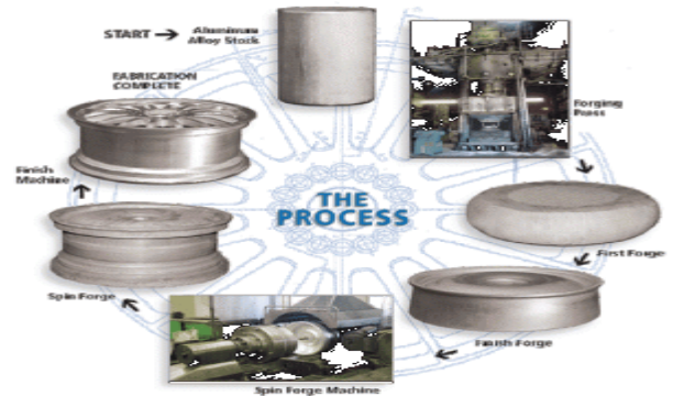
Gambar 2.2 Proses pembuatan velg sistem forging
