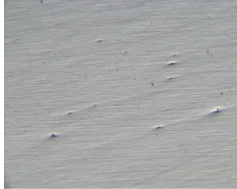
Gambar 4.1. Baja ST40 tidak di heat treatment
