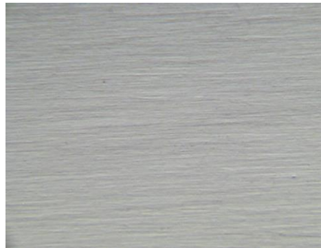
Gambar 4.2. Baja ST40 yang di heat treatment
