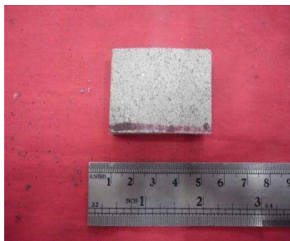
Gambar 10. Spesimen kampas rem Merk Mitsubishi
