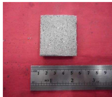
Gambar 12. Spesimen kampas rem Merk Indoparts
