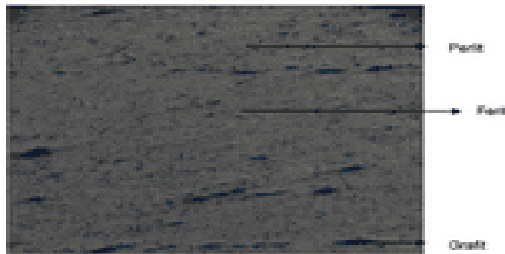
Gambar 8. Struktur mikro pena Pemukul senapan M16-A1 setelah diamati
