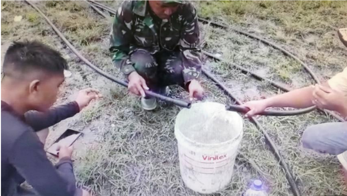
Gambar.8 Penghitungan debit air sampai titik tertinggi letak bak penampungan primer.
