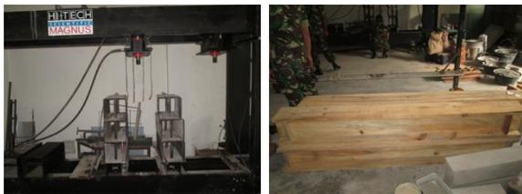
**Gambar 1.** Penyiapan Alat *Compression Test* dan Bahan Uji Papan Kayu Pinus
