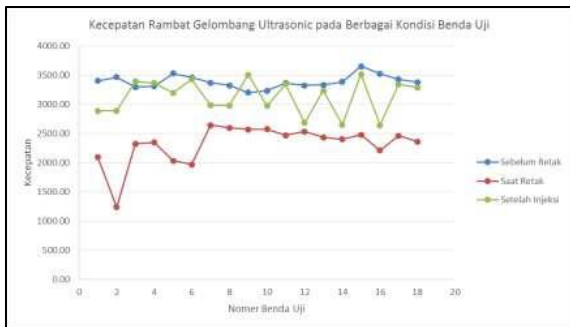
Gambar 3. Kecepatan Rambat Gelombang Ultrasonik dalam Uji UPV (Sumber: Herlambang, 2018)
