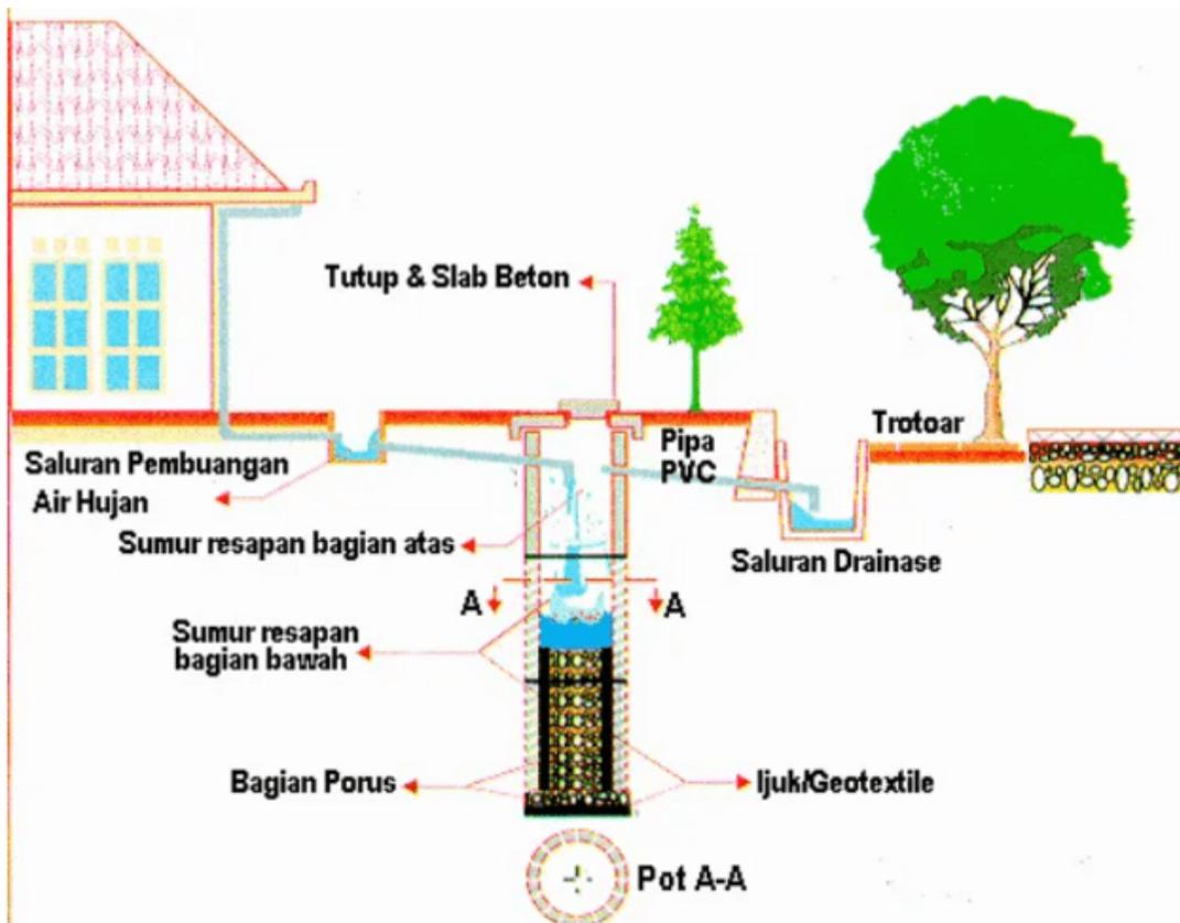
**Gambar 2.** Skema Bank Air dari penampungan air hujan
