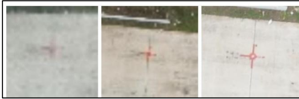
Gambar 3. Kualitas data mentah foto dari 3 PUNA: Phantom 4 Pro; Mavic 3E; WingtraOne Gen II (Sumber: Ahmad et al., 2024).
