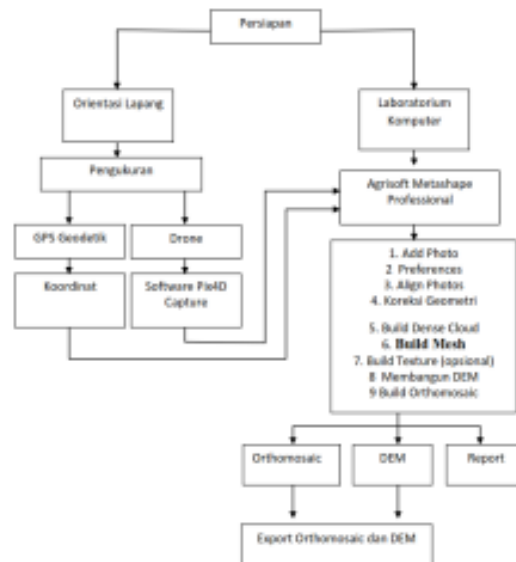
Gambar 5. Tahapan pemetaan dan pengolahan data menggunakan aplikasi Agisoft Photoscan (Sumber: jasa ukur, 2020).
