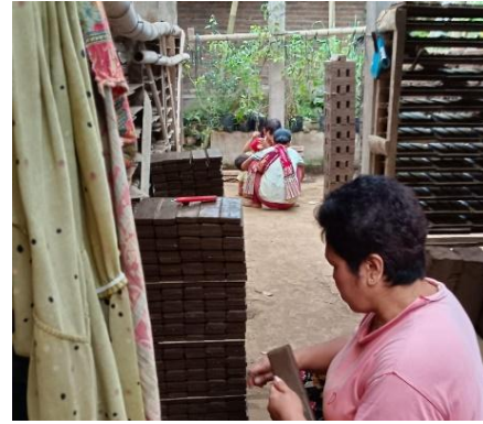
Gambar 6. Pengeringan batu bata press di Tempuran dengan sistem rak dan angin-angin
