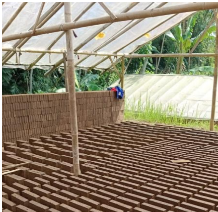
Gambar 5. Proses pengeringan batu bata di Mertoyudan dengan penutupan plastik (Sumber: Dokumentasi peneliti, 2025)
