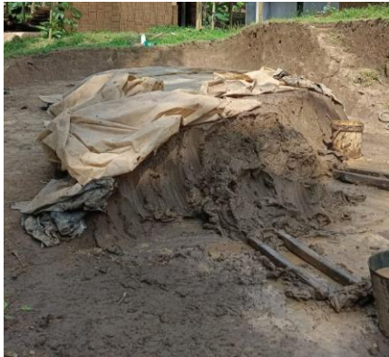
Gambar 1. Proses pengolahan tanah secara manual di Mertoyudan dengan cara menginjak-injak tanah (Sumber: Dokumentasi peneliti, 2025)
