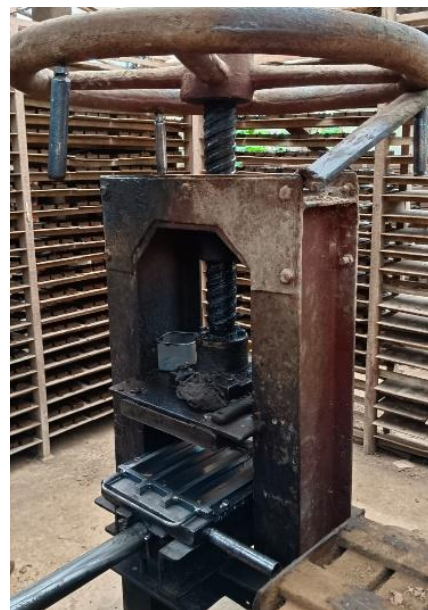
Gambar 4. Pencetakan batu bata menggunakan mesin press di Tempuran (Sumber: Dokumentasi peneliti, 2025)
