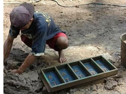
Gambar 3. Pencetakan batu bata tradisional menggunakan cetakan kayu di Mertoyudan (Sumber: Dokumentasi peneliti, 2025)
